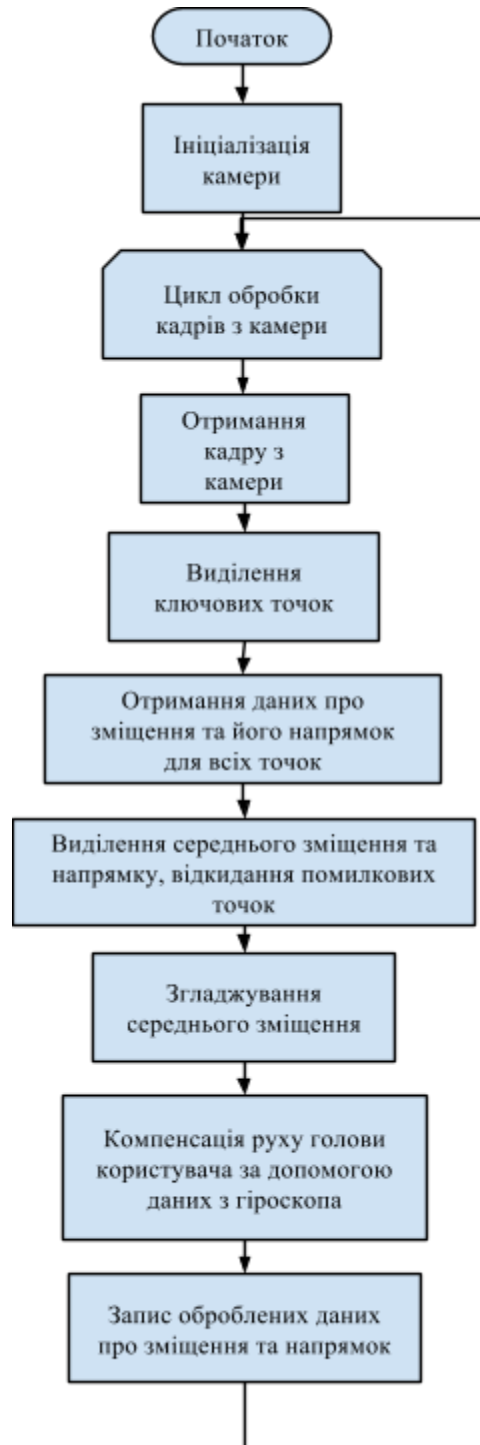
Рисунок 4.2 – Алгоритм роботи модулю комп'ютерного зору
