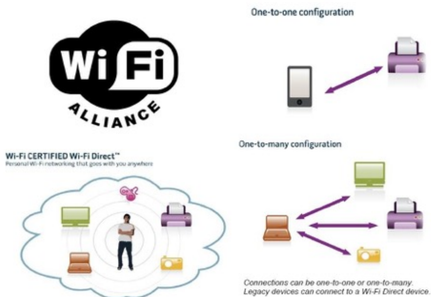
Рисунок 1.4 – Типи з'єднань Wi-Fi Direct [13]
